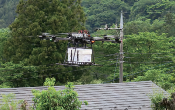
日本航空とKDDIが1人でドローン3機を遠隔操作する実験を実施。災害時を想定して防災備蓄品を運搬した。
