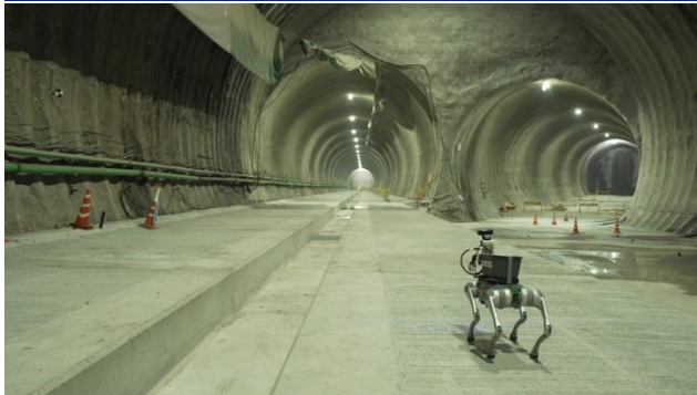
四足歩行ロボによる トンネル坑内の3Dスキャン
