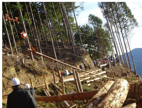
<架線式グラップルの遠隔操作の実演>
