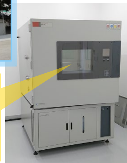
温度・湿度 試験設備
