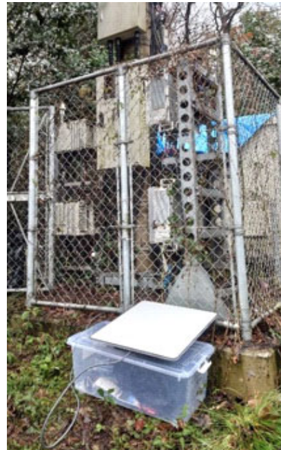
可搬型衛星アンテナ Starlink (KDDI)
