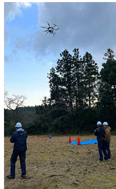
有線給電ドローン (ソフトバンク)
