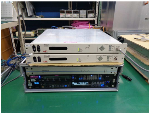
親局信号作成部 ・CDプレーヤー ・オーディオプロセッサ ・FM変調器
