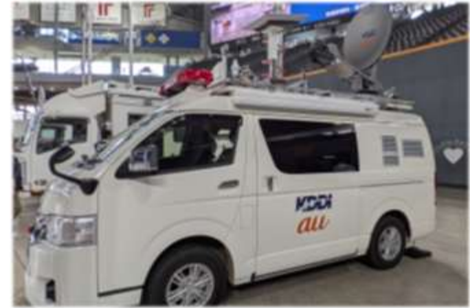
Starlinkを搭載した 車載型基地局
