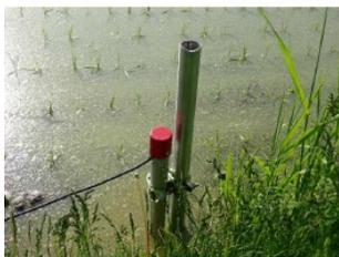
水位水温計測の自動化
