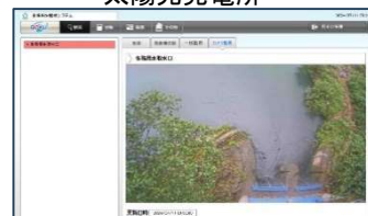
用水施設管理のIT化 (取水口遠隔監視システム)
