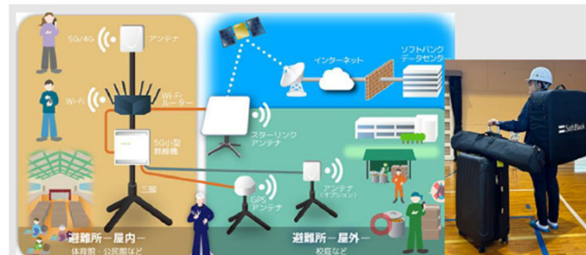
モバイル通信サービスと 無料Wi-Fiサービスを同時に提供 (能登半島等の大雨被害で運用)
