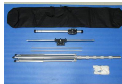
アンテナ(組立前)
