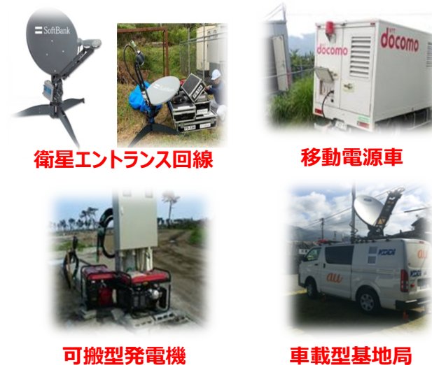
災害時における応急復旧機材の例
