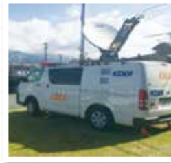
基地局と通信ビル間を結ぶ、 衛星による迂回回線の設置
