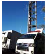
基地局等への 移動電源車の派遣
