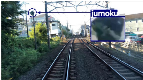
特殊信号発光器(五角形)の見通し支障検知例
