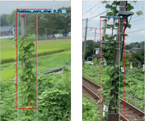
特殊信号発光器(縦型)の見通し支障検知例
