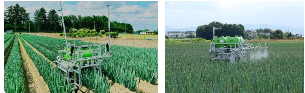
ねぎの自動農薬散布ロボット
