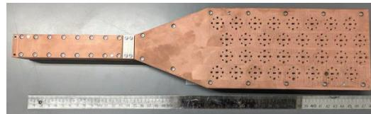
図 2-1-2-4 66GHz 帯 64 ビームアンテナと変換器の写真
