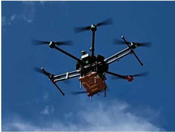
図 2-1-1-2 4ch 小型受信機を搭載したドローン
