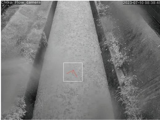
図 16 撮影された河川の映像の速度ベクトル
