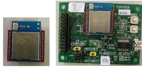
図 8 : 電力検出キャリアセンスを実装した LPWA モジュール (左) とその評価基板 (右)
