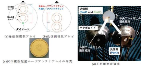
図 15 パラボロイドを用いた 28 GHz 帯ダイオード装荷ループアンテナアレイ長距離伝送の測定概要
