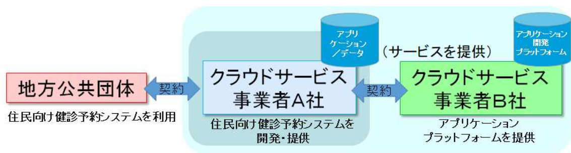
図表 14 クラウドサービスのサプライチェーン例の構成 (特定個人情報を扱わない場合)
