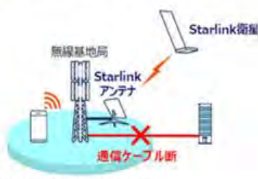
Starlinkのバックホール回線活用による復旧イメージ
