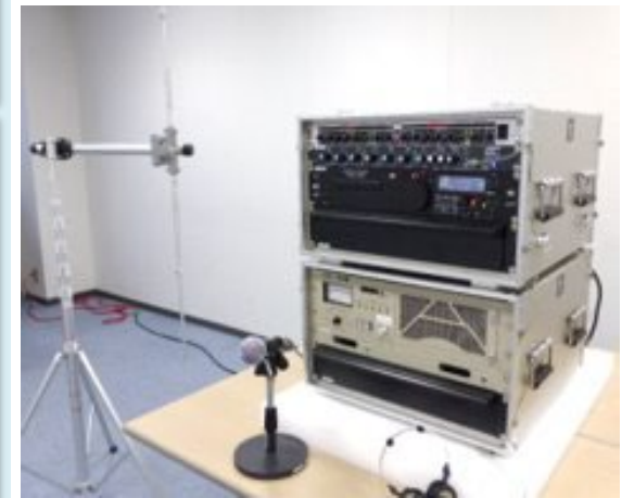
地方公共団体等への貸し出し用の臨時災害放送設備、アンテナ、マイク等
