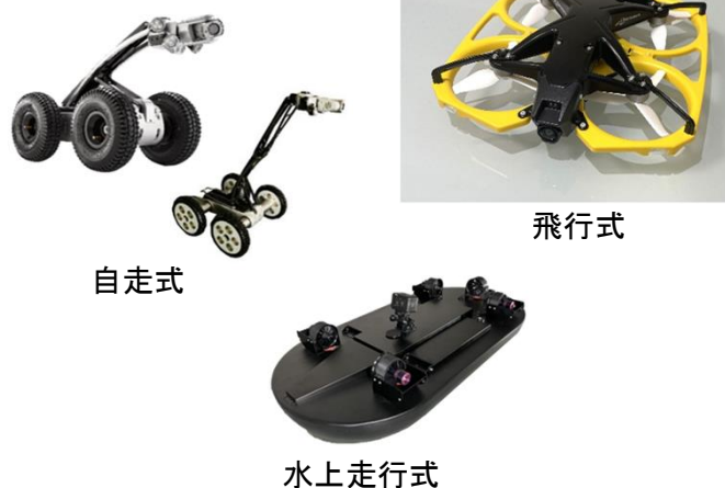
調査員が管渠内に入ることが不可能な場合に自走式カメラやドローン等を用いて、劣化状況を調査
