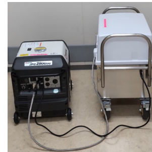
可搬型発電機 (ガソリンタイプ)
