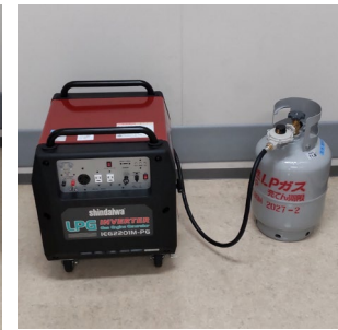
可搬型発電機 (プロパンガスタイプ)
