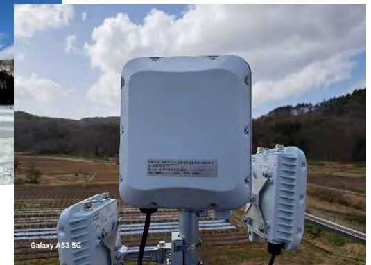
▼ アクセスポイントクラウドコントローラーにより遠隔で死活監視を実施
