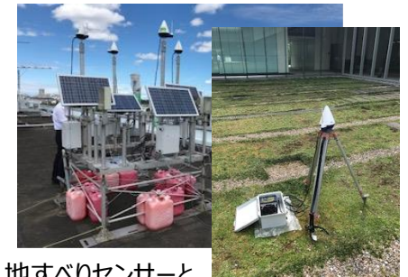
地すべりセンサーと ゲートウェイ機器
