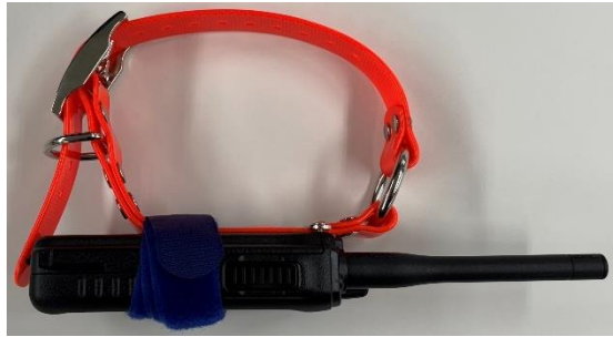
図 3-17 B:首輪下部に無線機(アンテナ一体)を単体で取り付けしたタイプ
