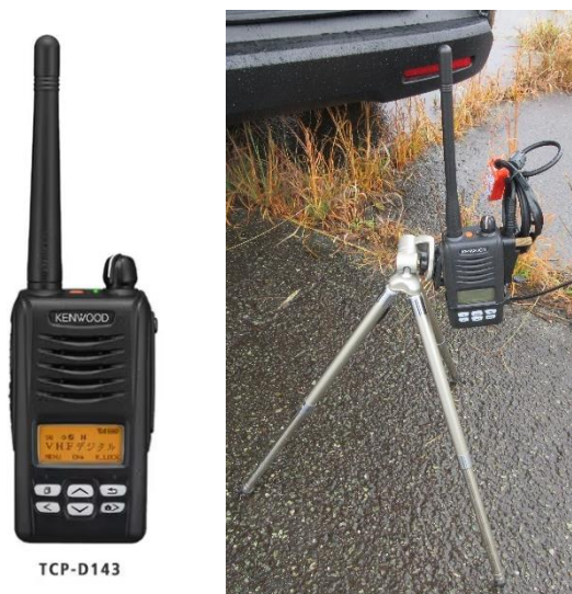
資料編 図 4 実験試験局無線機の外観
