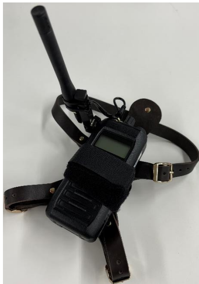
図 3-19 D:ハーネスに無線機を取り付け、ヘリカル短縮型のアンテナを垂直に取り付けたタイプ
