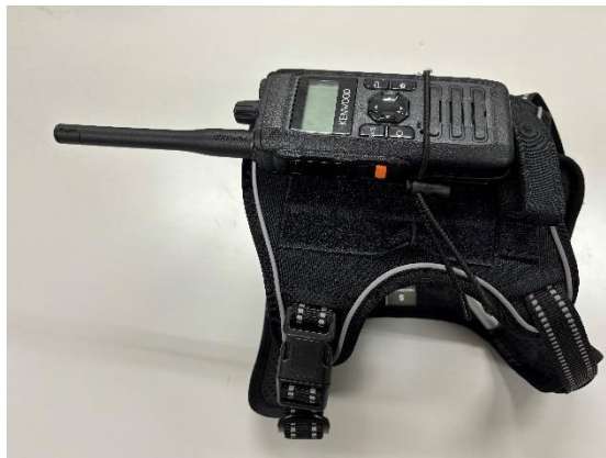
図 3-18 C:ハーネスに無線機(アンテナ一体)を単体で取り付けしたタイプ
