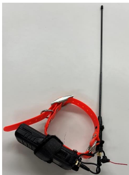
図 3-16 A: 首輪下部に無線機を取り付け、首輪横に 1/2\lambda のアンテナを取り付けたタイプ
