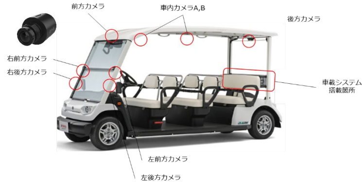
図1.1 監視カメラの取付位置
