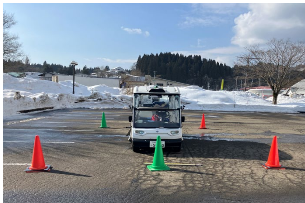
図2.4 自動運転車両周囲へのカラーコーンの配置図
