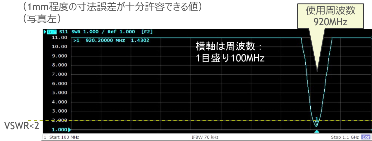
写真左：試作アンテナの定在波比(VSWR)特性（低い程良い） VSWR<2 の実用条件で20MHzの帯域幅を確認
