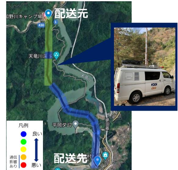
上空電波が悪い箇所周辺(大蛇ミニパーク)にStarlink搭載車載基地局を配置し、電波発射した場合の上空電波シミュレーション結果
