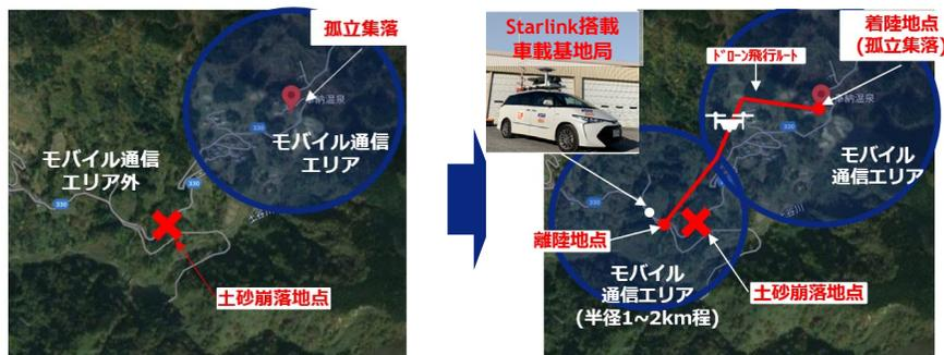
モバイル通信エリア外の場所にて、Starlink搭載車載基地局を用いて即座にエリア化し、ドローンによる物資配送を実現する
