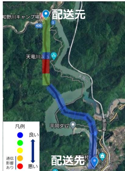
ドローン配送ルートにおける上空電波シミュレーション結果(Starlink搭載車載基地局無しの場合)
