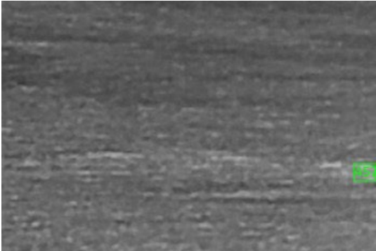
誤検知例 船舶が通過した後の波しぶきを検知
