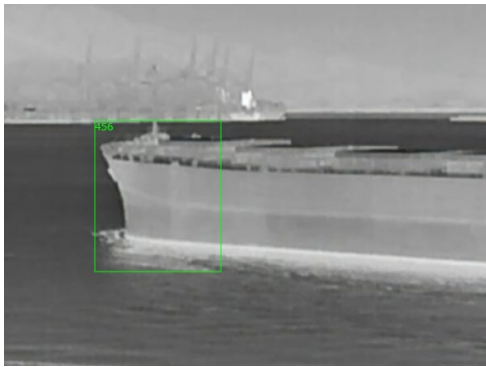
大型船舶の一部検知 ※一部検知は正検知と換算・まったく検知できない場合のみ未検知と換算
