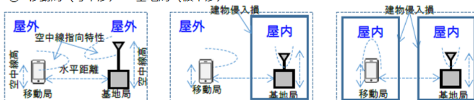
図 2. 1－16 26GHz 帯 5 Gシステム相互間の共用検討（同一周波数：同期運用）＜シナリオ 1-a＞
