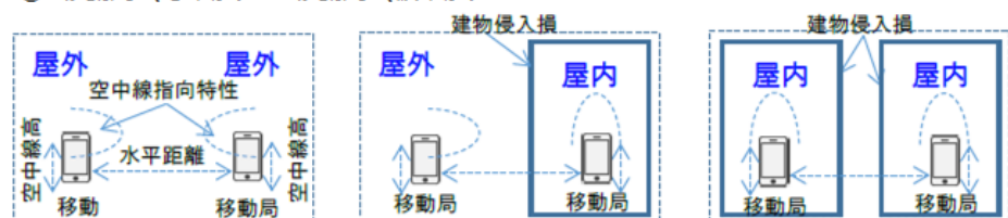
図 2. 1－21 26GHz 帯 5G システム相互間の共用検討（隣接周波数：非同期運用）＜シナリオ 2＞
