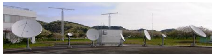
固定アンテナ 固定監視局のバックアップ(L,S,C,Ku,Ka帯)
