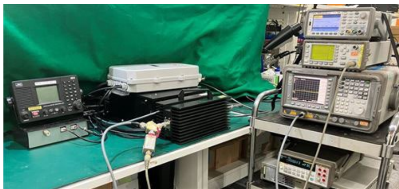
図 3-4 ACS 試作機の動作確認試験の測定系(送信系)
