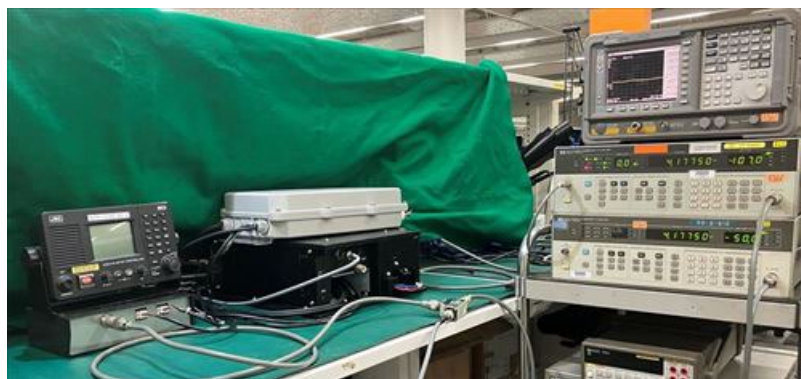
図 3-5 ACS 試作機の動作確認試験の測定系(受信系)
