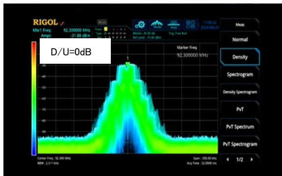
図4-32 回り込みD/U=0dB時の出力波形
