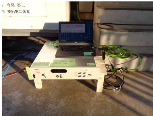
図7-3 FM回り込みキャンセラーの設置
