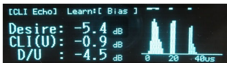
図 2-2 回り込み波の遅延プロファイル
