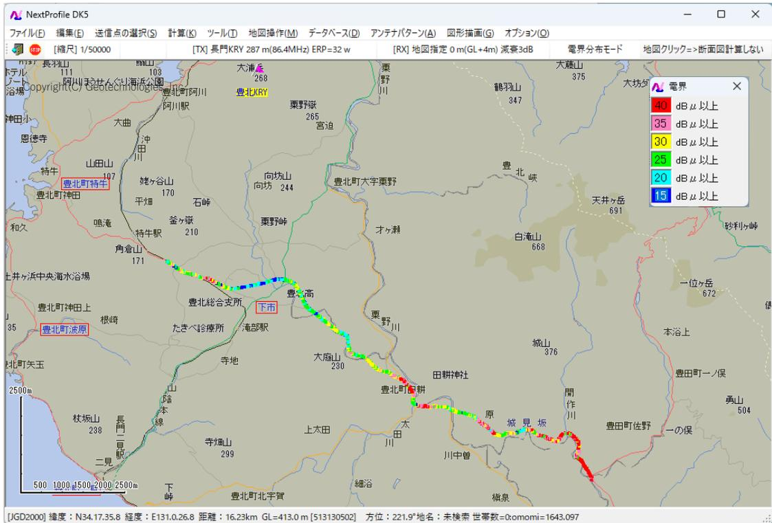
図5-69 豊北～豊田間 端子電圧分布図(豊北実験局±100Hz)
