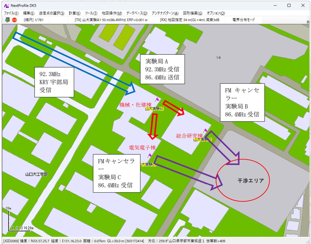
図5-19 山口大学常盤キャンパスでの実験イメージ
