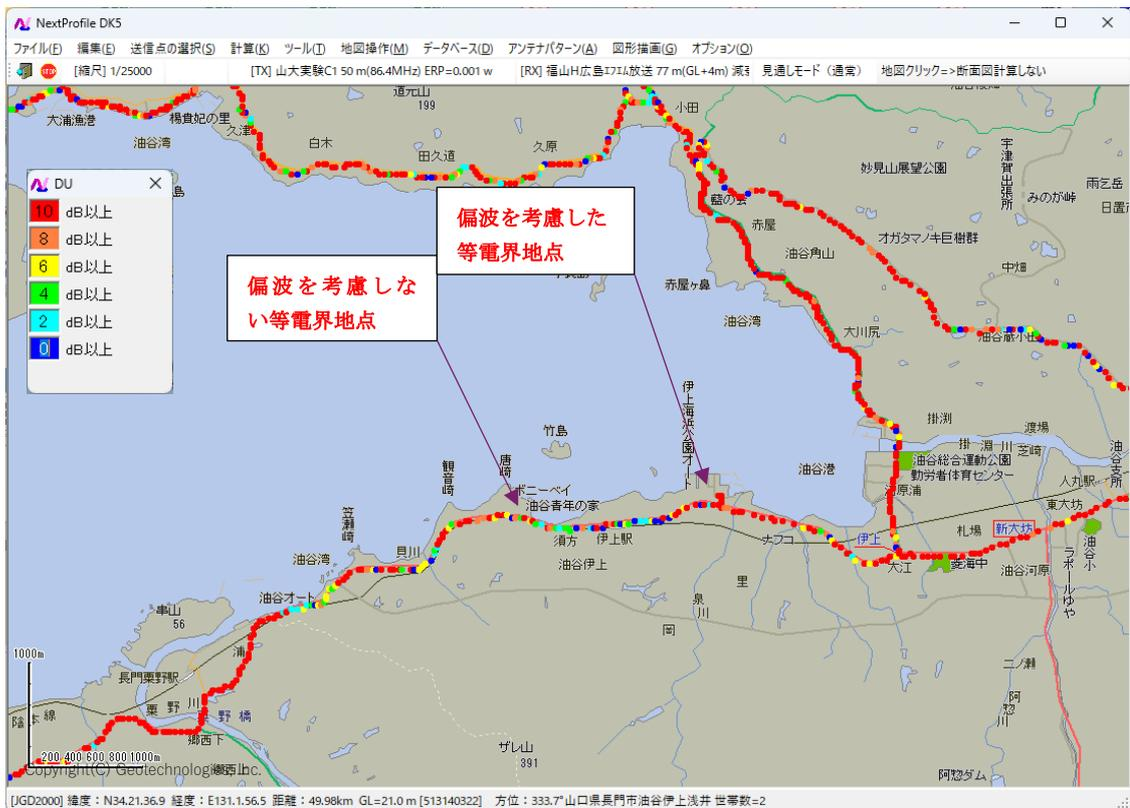
図5-80 豊北～長門間の端子電圧によるD/U分布図
