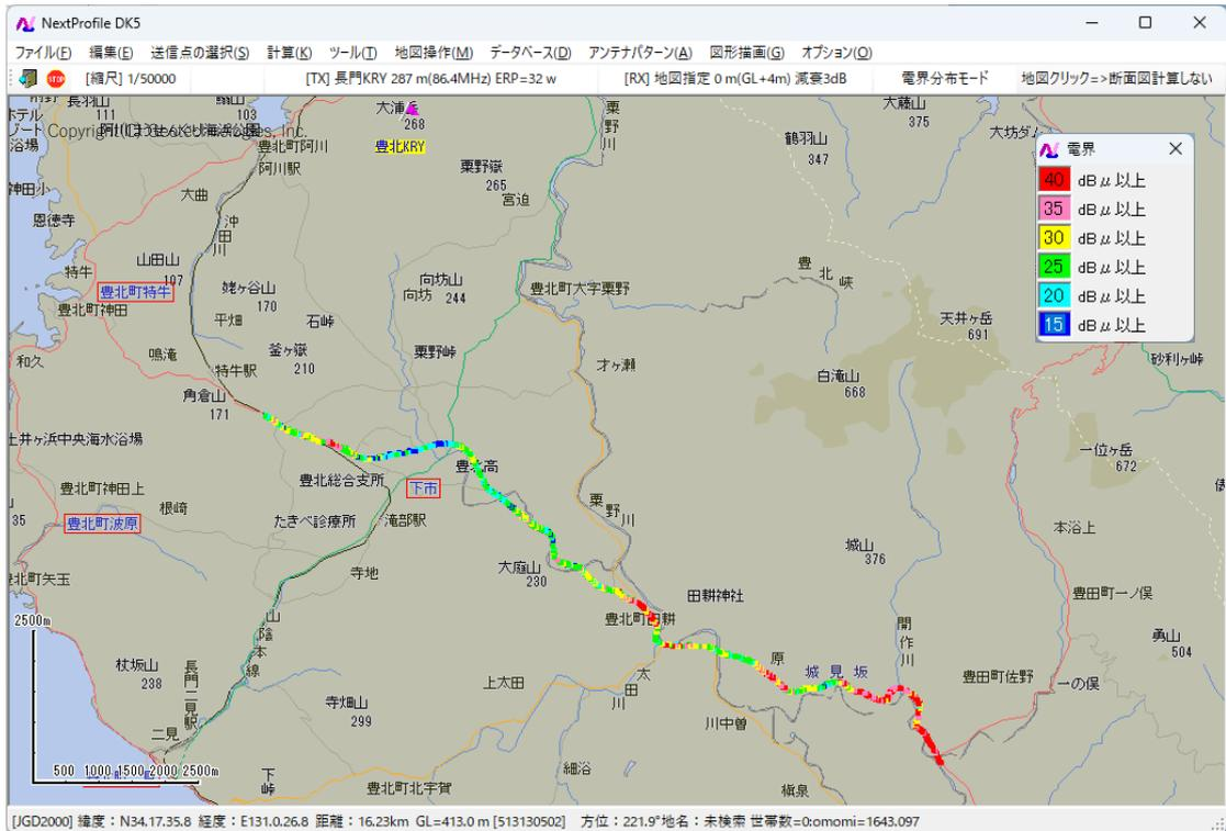
図5-67 豊北～豊田間 端子電圧分布図(豊北実験局—100Hz)
