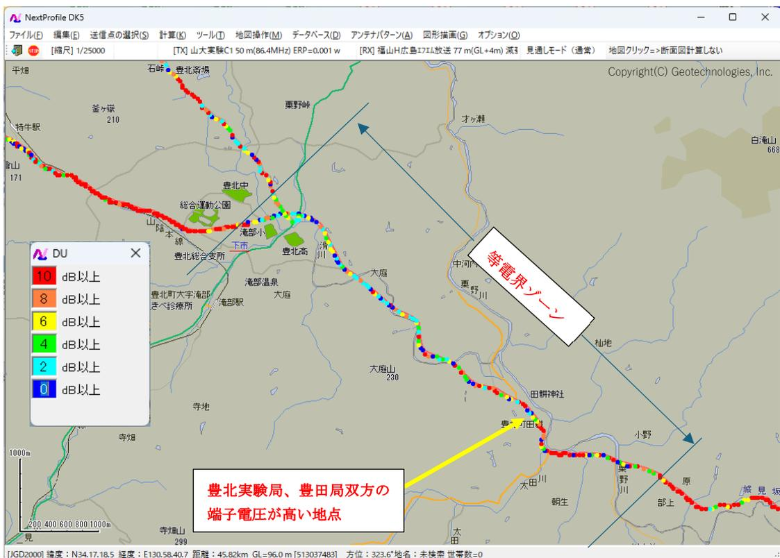
図5-82 豊北～豊田間の端子電圧によるDU分布図
