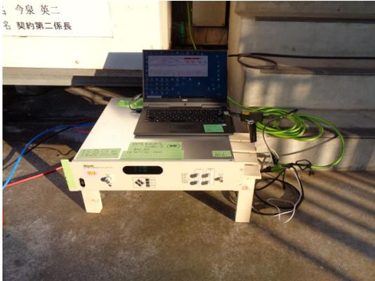
図7-3 FM回り込みキャンセラーの設置
