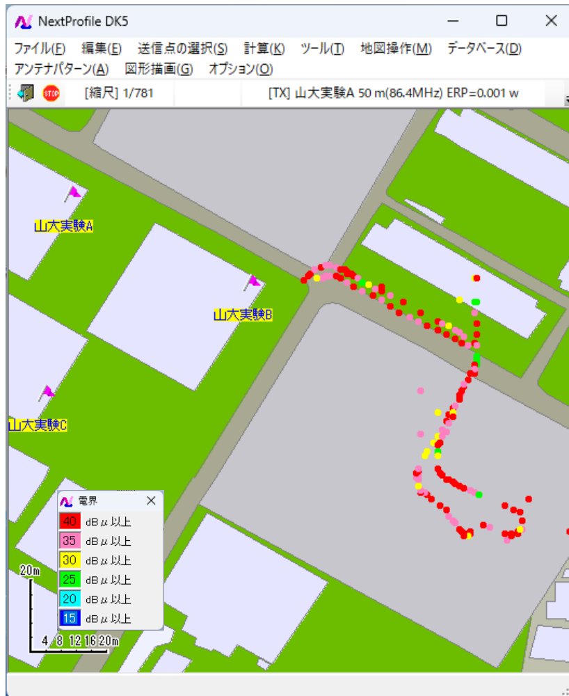
端子電圧の分布を地図上に色分けして表示した例
