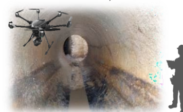
(管路等劣化状況点検用ドローン)
