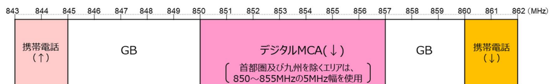
図 2. 3-1 800MHz 帯（843～862MHz 帯）の周波数使用状況
