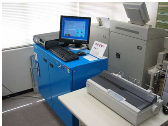
線量計読取装置（TLD 自動読取装置）
