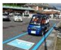
路上駐車対策 (走行位置の明示)
