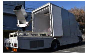
図3今回開発した可搬型光地上局と直径35cm望遠鏡の外観
