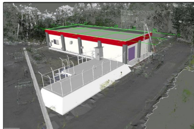
老朽化更新により信頼性向上させ、かつ再配置より浸水リスク等を考慮した受電室
