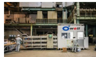
O-well社の自動リブレット形状塗膜施工システム
