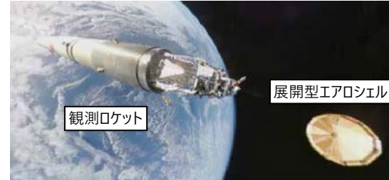
大型展開型エアロシエルの観測ロケット実験
