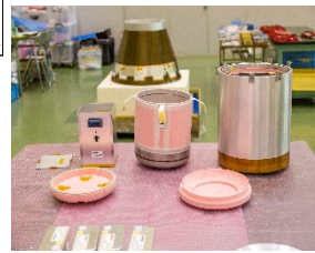
民間と開発した真空二重断熱容器(魔法瓶方式)
