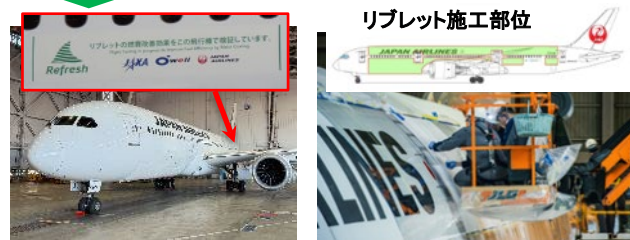
787機へのJAL整備士によるリブレット施工の様子
