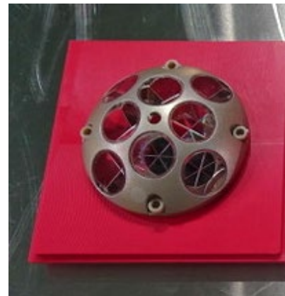
NASAから提供を受けたLRA（Laser Retroreflector Array）. 再帰反射性があり、光を、光が入射してきた方向に向かって反射することができるミラーが複数配置されている。質量約21g
