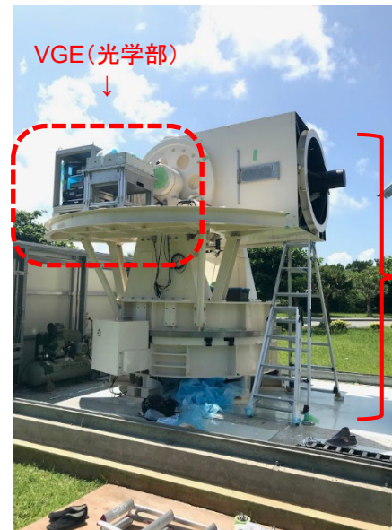
図5: NICT沖縄電磁波技術センターのNICT光地上局 に設置したチェックアウト装置(VGE)
