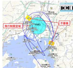
図2 不審機自動識別をしているD-NET画面 飛行制限空域に侵入の可能性が高い機体を自動で識別。 監視のワークロードが大幅に低減。
