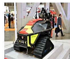
【無人走行放水ロボット】
