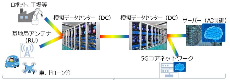
実環境を模したエンドエンド（通信の経路全体）での構成 ※マルチベンダでの接続検証環境を構築
