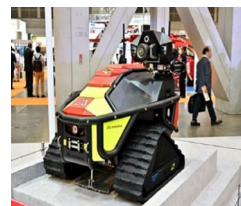
【無人走行放水ロボット】
