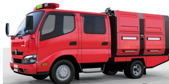
（小型動力ポンプ積載車（3.5t未満））
