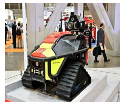
【無人走行放水ロボット】
