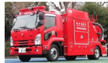
【高度土砂吸引車】
