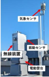
図 300GHz 帯屋外伝送装置
