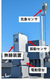
図 300GHz 帯屋外伝送装置
