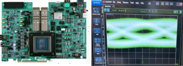
図 開発した信号処理基板と 25Gbps の出力波形
