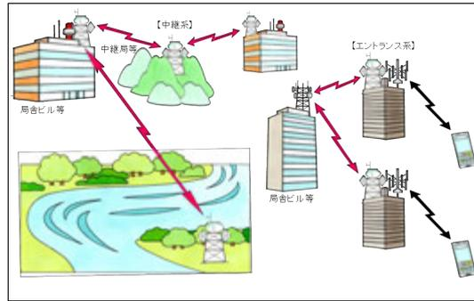
6.5GHz 帯電通・公共・一般業務(中継系・エントランス)は、音声、データ及び画像(映像を含む)などの多様な情報を伝送する無線通信システムであり、雨や霧による影響が少ないことや広い帯域を使用できることから、中長距離の通信に適しており、おおむね 50km までの長スパンにおいて用途に応じた伝送(6Mbps~208Mbps)に利用されている。
