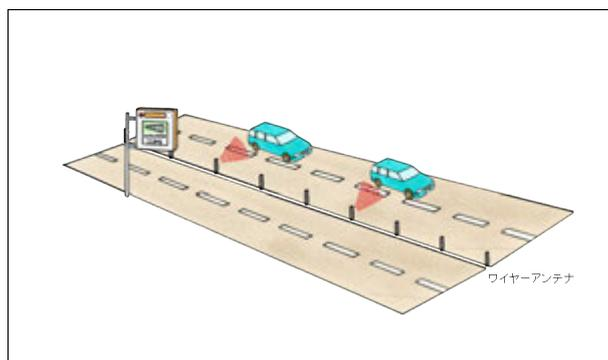
路側通信(MF帯)(特別業務の局)は、国道等で一般車両に渋滞、事故等の道路交通情報を提供するための無線通信システムである。
