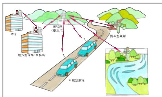
災害対策・水防用無線（60MHz 帯）は、水防ダム、砂防ダム等の保守管理に使用しており、山間部等見通し外通信が主な地域における音声通信用の無線通信システムである。
