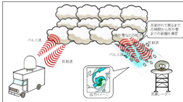
5GHz 帯気象レーダー・5GHz 帯空港気象レーダー (C 帯) は、全般的な気象観測等を行う気象レーダーであり、波長が 5cm 程度で降雨減衰が少なく、観測範囲が 200~300km といった広域にわたる雨雲の状況を観測することに適している無線通信システムである。
