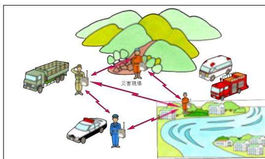
防災相互波（150MHz 帯）は、大規模災害時において、防災機関等が連携し円滑な対応を行うために、関係機関間で必要な連絡手段として使用する無線通信システムである。
