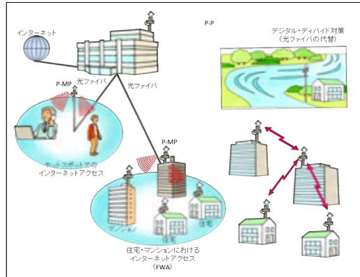
5GHz 帯無線アクセスシステム (4.9GHz 超 5.0GHz 以下) は、無線アクセス用として利用されている無線通信システムであり、国による利用は、災害対策支援船が災害対策本部等と通信するため、荒川沿いに基地局を設置し、運用されている。
