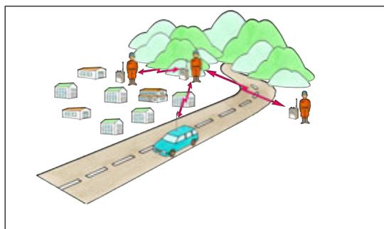
部内通信(災害時連絡用)(150MHz 帯)は、災害発生時又は訓練時に車両又は出先における職員との連絡用に使用する無線通信システムである。
