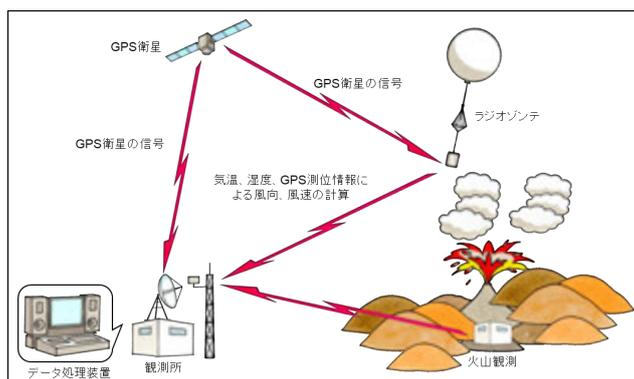
気象援助用無線（400MHz 帯）は、気象情報等を観測し、観測データを観測所に伝送する無線通信システムである。
