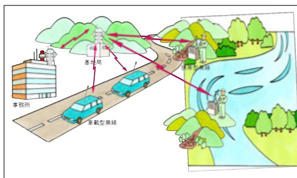
水防用(60MHz 帯、150MHz 帯)は、水害の予防・復旧対策のため必要なデータの取得や、関係者間の音声連絡用に使用する無線通信システムである。
