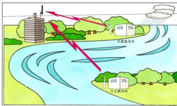
公共業務用テレメータ（災害対策・水防事務を除く）（60MHz 帯）は、テレメータとして利用されている無線通信システムであり、調査対象の関係府省庁においては、航路標識（主に海上標識）の灯火等の状況を確認するため標識と運用所の間で監視信号を伝送するために利用されている。
