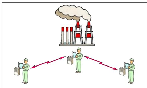
石油備蓄（150MHz 帯）は、国家石油備蓄基地（むつ・秋田・菊間）で使用している音声連絡用の無線通信システムである。
