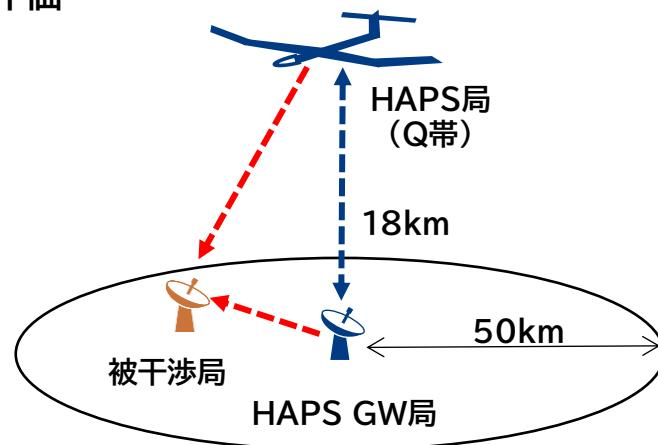
既存システム無線局の位置を変更し各位置での干渉量を評価
