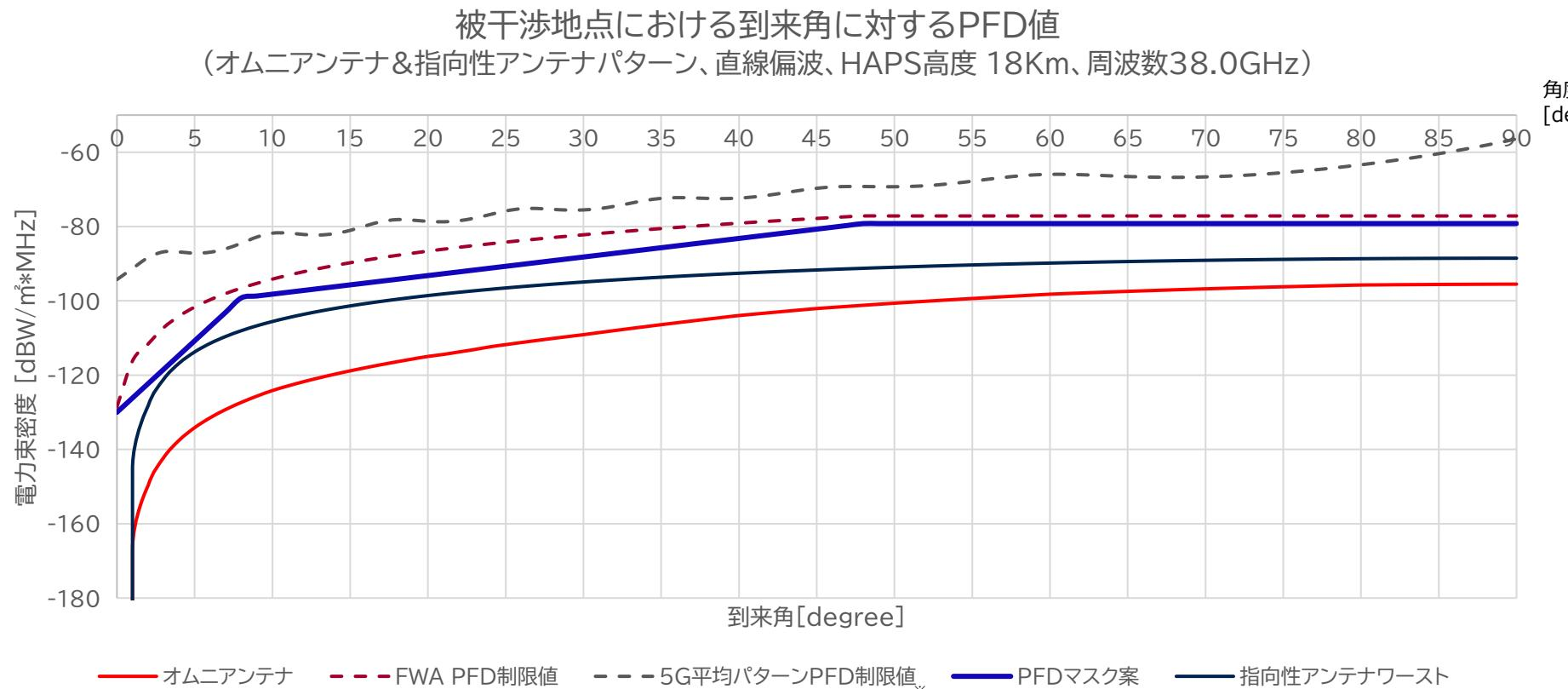
※)令和2年度新世代モバイル通信委員会報告における「地球局からローカル5Gへの干渉影響に関する共用検討(隣接帯域)」において、5G基地局の空中線指向特性はビームフォーミングにより常に変動しており、最大利得を持つビームからの干渉が連續的に生じるとは考えにくいため、平均パターンに基づく結果のみ掲載している。また、HAPSは上空18-20km程度を飛行しており、位置も時々刻々変化することを勘案し、静止している無線局同士よりも最大利得で指向性が向く可能性は低いため、本件でも平均パターンを採用。
