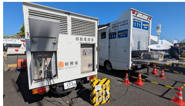
【当局の移動電源車から NTT西日本の衛星通信移動無線車に電源を供給】
